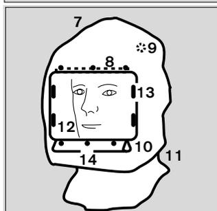
Suleika II ist ein offener Atemanschluss mit Gefahr des "Überatmens", d.h. bei Ausfall oder Schwächerwerden der Luftversorgung ist kein ausreichender Schutz gewährleistet. Deshalb **nicht einsetzen** gegen krebserzeugende, sehr giftige und radioaktive Stoffe, Mikroorganismen (Viren, Bakterien und Pilze und deren Sporen) und gegen Enzyme oder bei Sauerstoffmangel in der Umgebungsluft.
