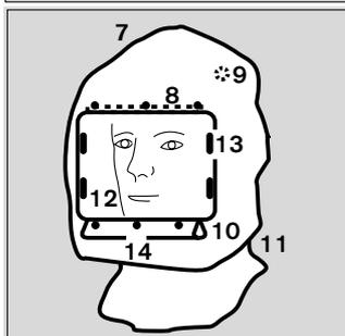
El Suleika II es una conexión respiratoria abierta con el peligro de una „sobre-respiración“, es decir, en el caso de un fallo o de una reducción de la alimentación de aire no se garantiza una protección satisfactoria. Por ello, este equipo **no debe emplearse** frente a sustancias cancerígenas, muy tóxicas y radioactivas, microorganismos (virus, bacterias y hongos y sus esporas), así como frente a enzimas o, en el caso de una insuficiencia de oxígeno, en el aire ambiental.
