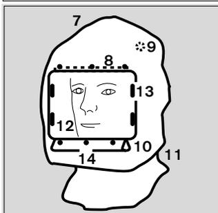
Le Suleika II est une pièce faciale ouverte et risque, en cas de panne ou de baisse du débit d'alimentation en air, de ne plus offrir une protection suffisante. Aussi, **ne pas l'utiliser** contre des substances cancérigènes, toxiques et radioactives, des micro-organismes (virus, bactéries et moisissures et leurs spores), des enzymes, ni en cas de défaut d'oxygène dans l'air ambiant.
