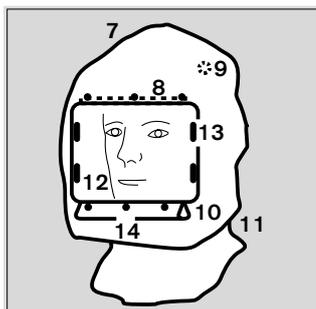
Suleika II je otevřený dýchací přívod s nebezpečím "přidýchávání", tzn. při výpadku nebo zeslabení zásobování vzduchem není zaručena dostatečná ochrana. Z tohoto důvodu **nepoužívejte** proti karcinogenním, velmi jedovatým a radioaktivním látkám, mikroorganizmům (virům, bakteriím, houbám a jejich sporám) a rovněž proti enzymům nebo při nedostatku kyslíku v okolním vzduchu.
