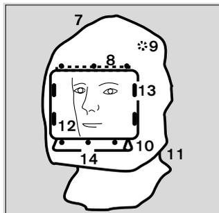
O aparelho Suleika II é uma conexão respiratória aberta com perigo de "respirar excessivamente", quer dizer quando o abastecimento do ar falha ou enfraquece, não é garantida nenhuma protecção suficiente. Por isto, **não utilizá-lo** contra substâncias cancerígenas, muito tóxicas e radio-activas, microorganismos (virus, bactérias e fungos e os seus esporos) e contra enzimas ou no caso de uma falta de oxigénio no ar ambiente.
