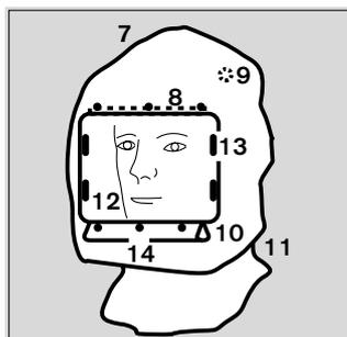
Η συσκευή Suleika II είναι ένα ανοιχτό αναπνευστικό σύστημα με κίνδυνο «αναπληρωματικού αερισμού», δηλαδή, δεν εξασφαλίζει επαρκή προστασία σε περίπτωση αστοχίας ή πτώσης της τροφοδοσίας αέρα. Για τον λόγο αυτό, **δεν πρέπει να χρησιμοποιείται** για την προστασία από καρκινογόνες, πολύ δηλητηριώδεις ή ραδιενεργές ουσίες, μικροοργανισμούς (ιούς, βακτηρίδια, μύκητες και τα σπόριά τους) ή ένζυμα, ή σε περίπτωση έλλειξης οξυγόνου στην περιβάλλουσα ατμόσφαιρα.
